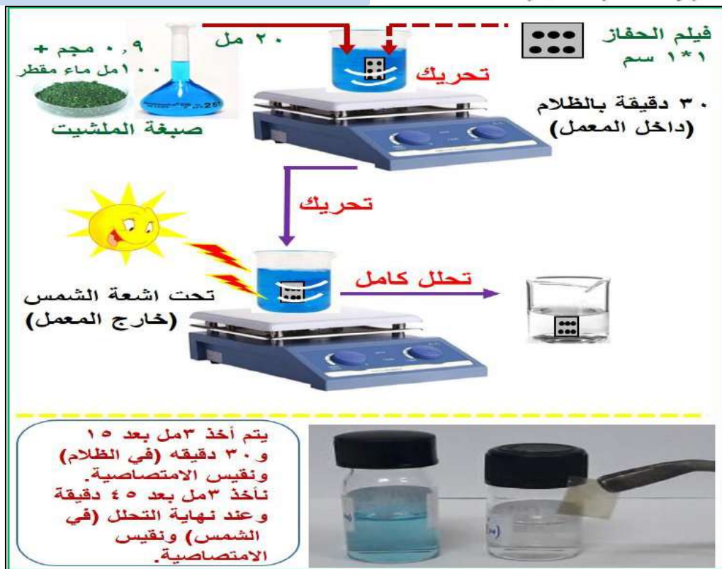
الشكل (5) تحضير المحلول الأزرق لصبغة الملشيت الخضراء وطريقة عمل التحلل الضوئي باستخدام الحافز الضوئي (بوليمر- نانو كربون)
